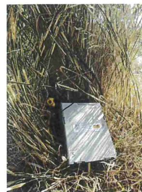
Enregistreur automatisé de type SM2 installé sur l'aire d'étude - Photo in situ
